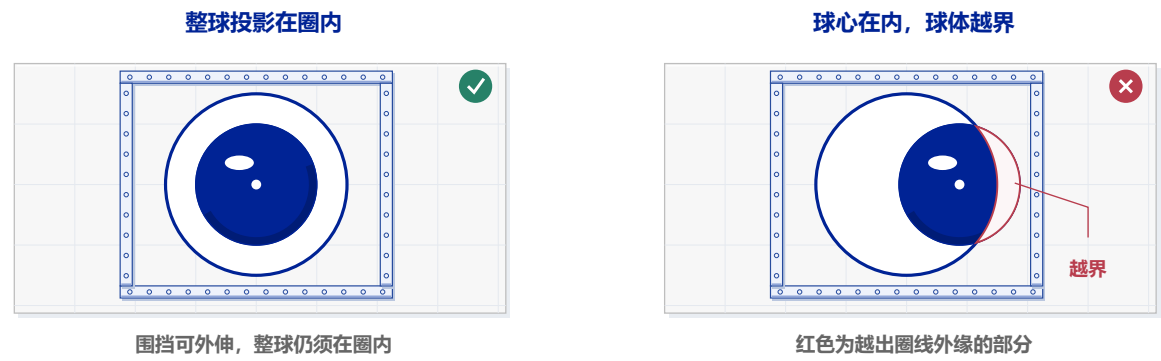
图10 右图红色部分为越界投影，判定边界取蓝色圆线外缘。
